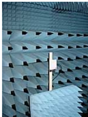
Antena w trakcie badań w komorze bezodbiciowej.
